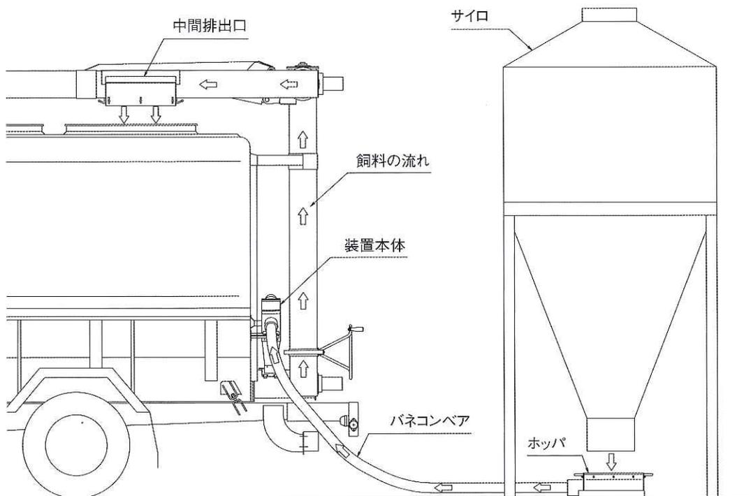
抜取装置の車載イメージ
